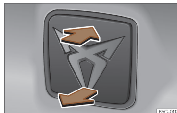
Billede 89 Bagklap: åbning udefra
