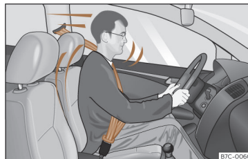
Billede 33 Hvis sikkerhedsselen er spændt korrekt, bliver føreren ikke kastet frem ved en pludselig opbremsning.
