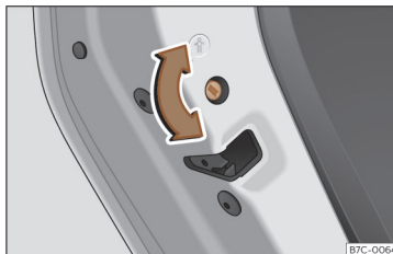
Billede 88 Børnesikring i venstre dør
