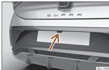
Billede 123 I den bageste stødfanger: placering af bakkamera
