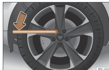
Billede 200 Hjulskift: løsning af hjulbolte
