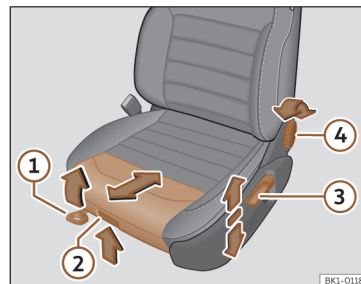
Billede 95 Forsæder: manuel sædeindstilling
